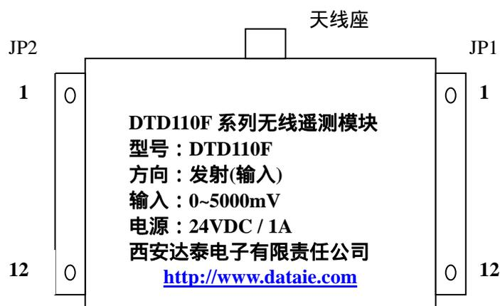
图 3 发射模块外接端子示意图
